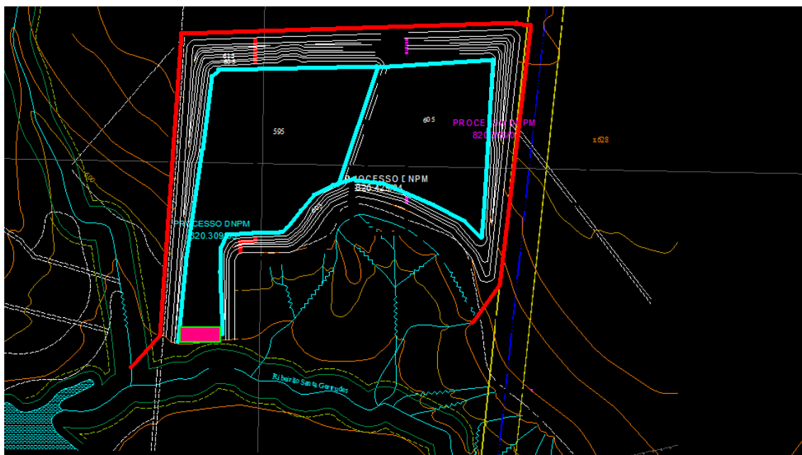
Figura 5.4.5.2- 9 – Esquema dos canais de drenagem externos (vermelho) e interno (azul) e a estrutura filtrante – área – DNPM – 820.368, 820.429 e 820.309 – Painel 7
