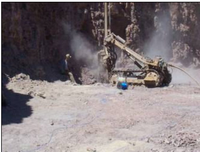
Foto 5.3.1-2: Operação de perfuração, com o emprego de perfuratriz pneumática, para o desmonte do minério por explosivos (foto tomada no empreendimento, à época de seu funcionamento).
