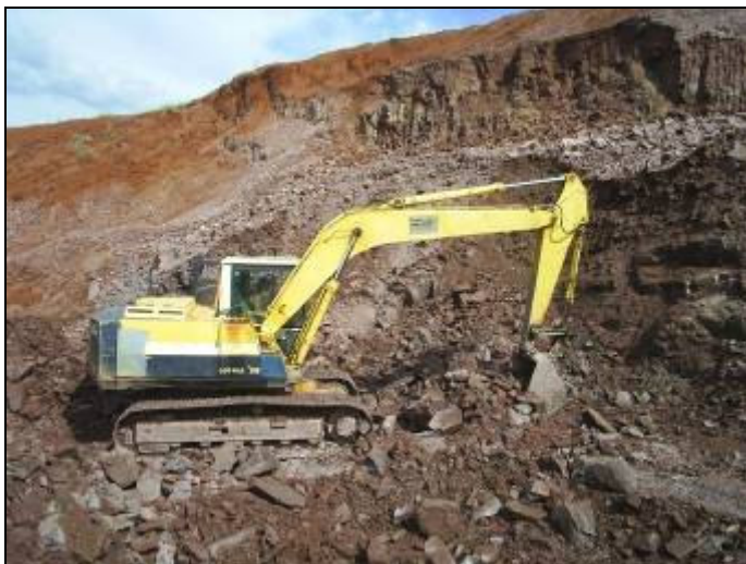
Foto 5.3.1-1: Operação de desmonte mecânico do minério, com o emprego de retroescavadeira (foto tomada em empresa de mineração da região).
