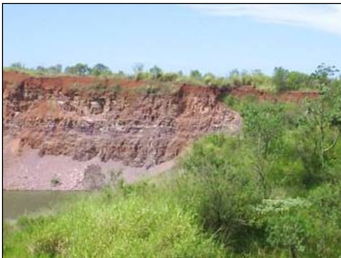
Foto 5.1.9-2: Taludes e bermas da área lavrada – porção sul - na área da poligonal do processo DNPM 820.415/99.
