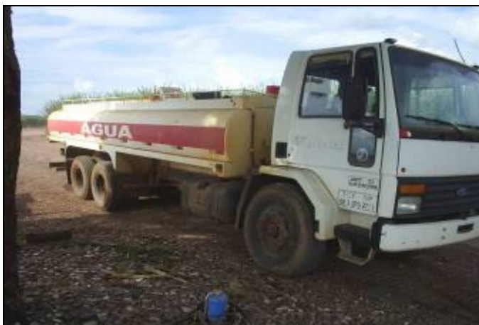
Foto 5.4.5.4-2: Caminhão-pipa utilizada na umectação de acessos em mineração da região; este tipo de controle de poeiras geradas pelo tráfego de caminhões também será adotado no Complexo Argileiro.
