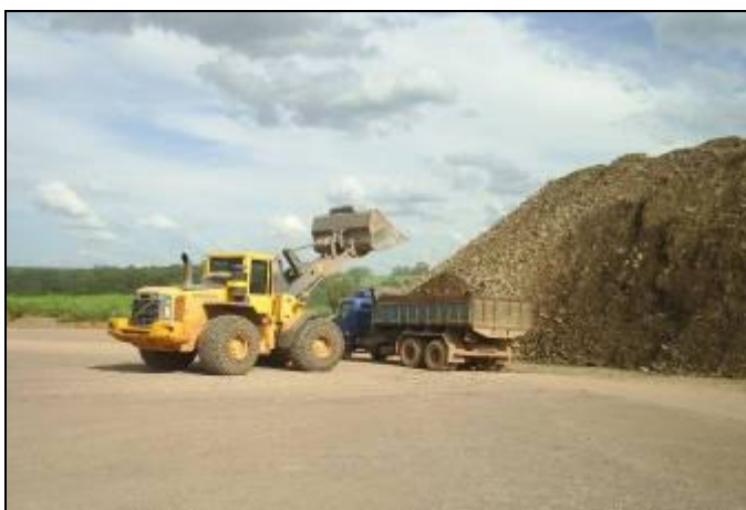
Foto 5.3.1-3: Operação de retomada de pilha de minério por pá carregadeira e carregamento em caminhão basculante, para expedição às indústrias cerâmicas (foto tomada em empresa de mineração da região).
