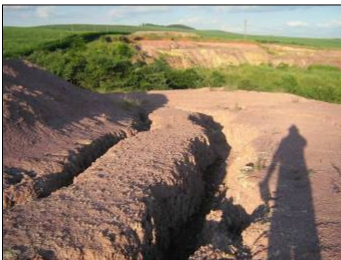
Foto 5.2.1.1-1: Sulcos de erosão na parte superior do depósito de argila.
