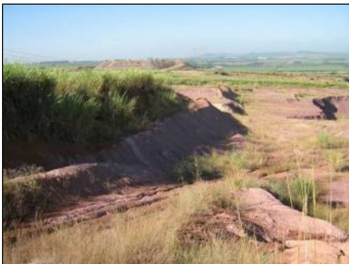
Foto 5.2.1.2-3 Aspectos dos sulcos de erosão que estão se desenvolvendo na área minerada. Parte do material carreado se dirige para a área do processo DNPM 821.162/99 situada à jusante (ao fundo e à direita da foto).
