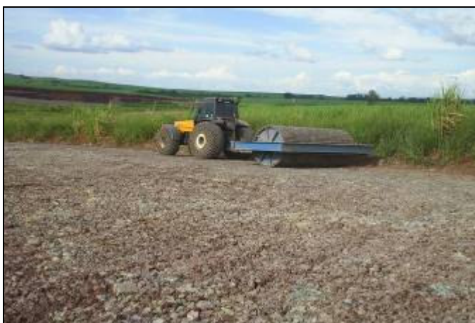
Foto 5.3.2-4: Operações de secagem ao ar livre e cominuição inicial do minério por rolo compressor (foto tomada em empresa de mineração da região). Estas operações não serão mais desenvolvidas na área do Complexo Argileiro quando da retomada das atividades.
