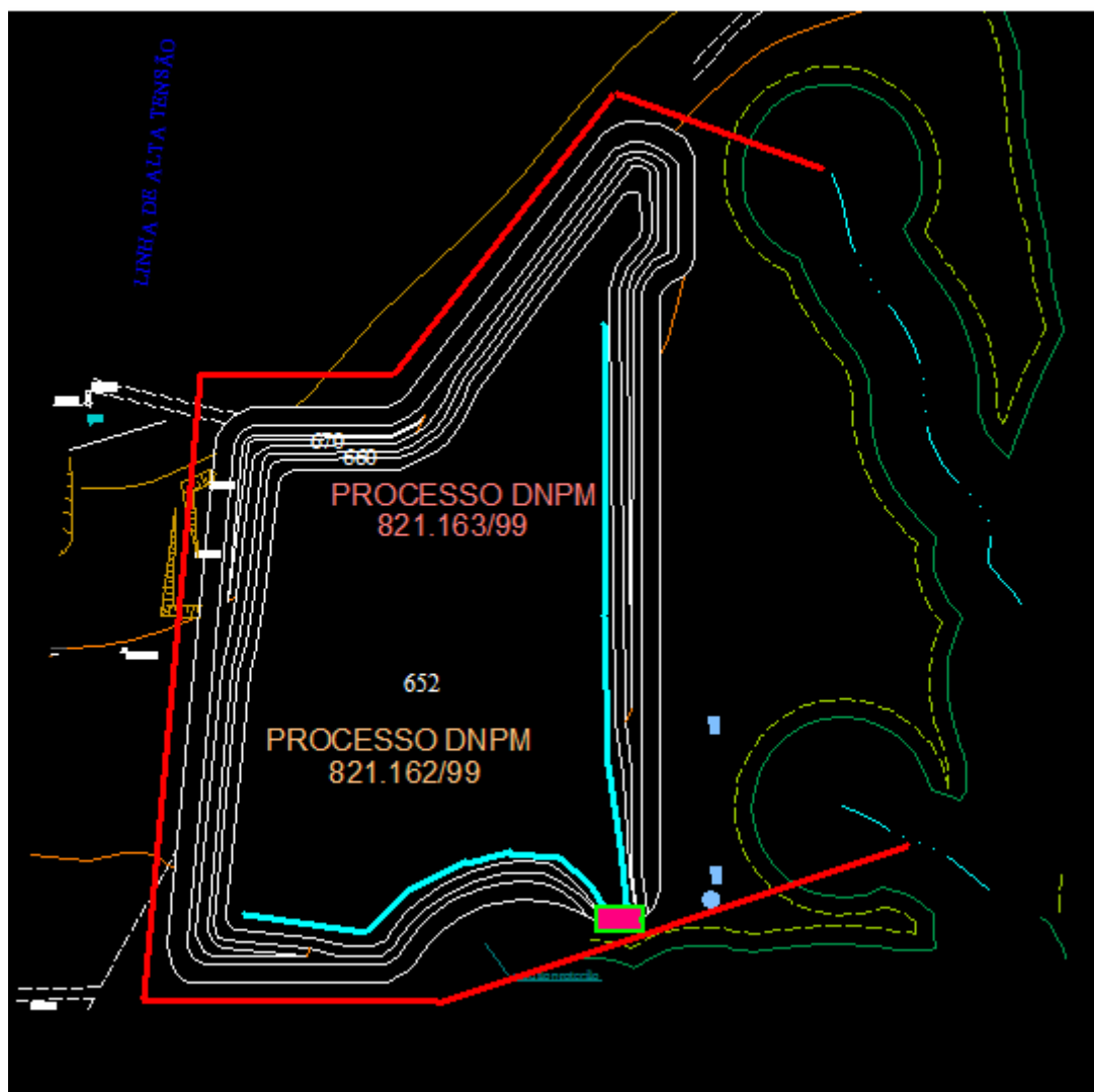
Figura 5.4.5.2- 5 – Esquema dos canais de drenagem externos (vermelho) e interno (azul) e a estrutura filtrante – área – DNPM – 821.163 e 821.162 – Pannel 2
