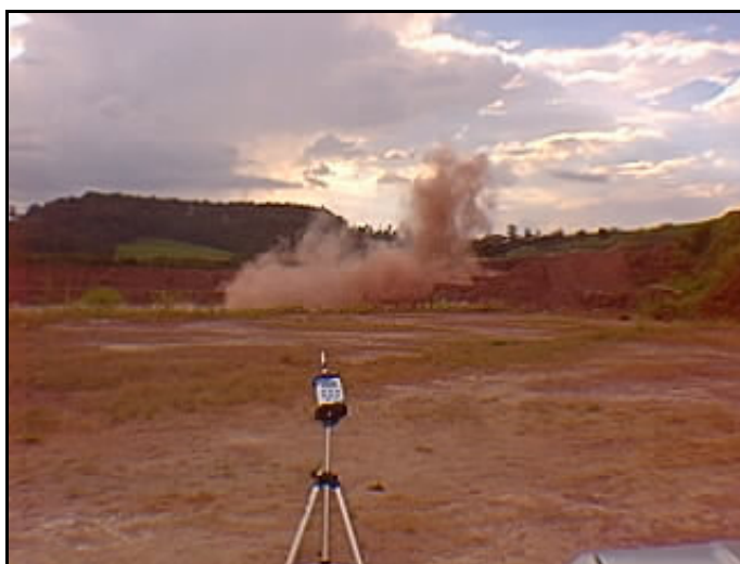
Foto 8.2.1-1 – ilustra as medições de ruído gerado por detonação diretamente na cava.
