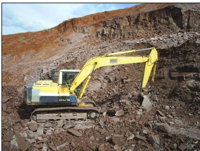
Foto 2.2-1: Operação de desmonte mecânico do minério, com o emprego de retroescavadeira.
