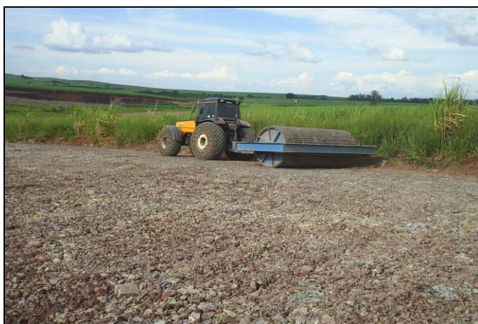
Foto 2.2-4: Operações de secagem ao ar livre e cominuição inicial do minério por rolo compressor. Esta atividade não será desenvolvida no Complexo, e sim em pátios de secagem devidamente licenciados.
