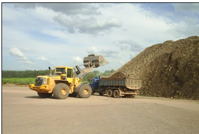
Foto 2.2-3: Retirada de minério de pilha por pá carregadeira e carregamento em caminhão basculante, para transporte aos pátios de secagem.
