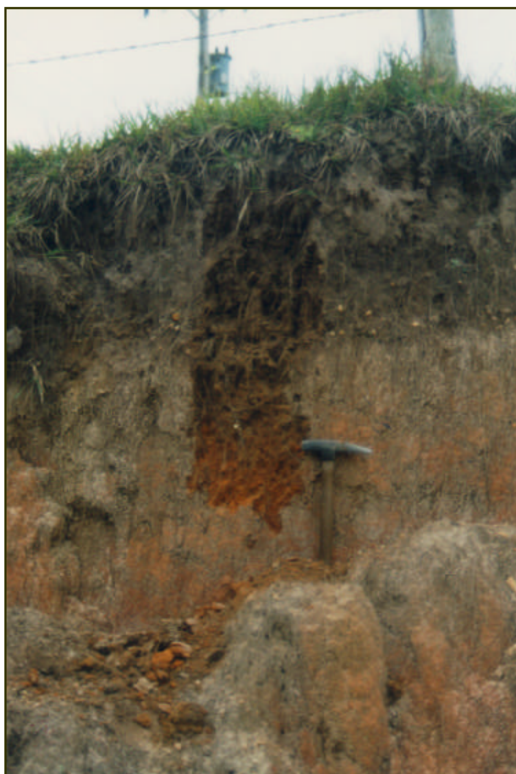
DS. 3 - Solo PV Podzólico Vermelho amarelo com cascalheira, situado na AII, apresentando horizonte Bt (B textural) incipiente sobre horizonte B1 (B latossólico), perfil este característico do processo de dissecação do relevo.
