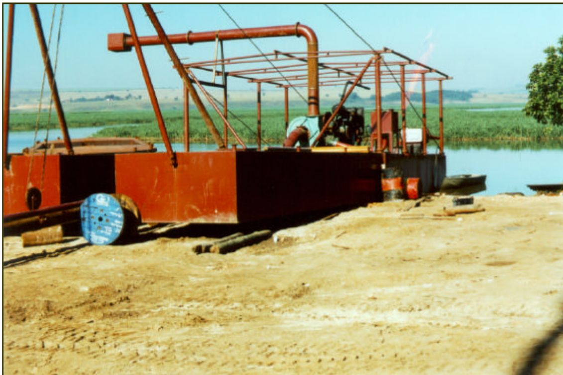
RM. 12 - Draga da Arezan. Nota-se o desmatamento da Mata Ciliar realizado para nova frente de lavra.
