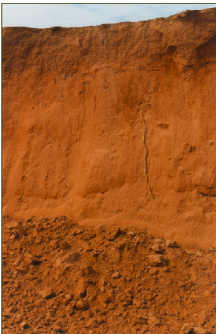
DS. 1 - Exemplo de perfil AQ Areia Quartzosa, característico da região de São Pedro, AII, apresentando perfil espesso e homogêneo. Área de empréstimo localizada no entrocamento da estrada de ligação Águas de São Pedro / São Pedro, com a estrada Charquead / Santa Maria da Serra.
